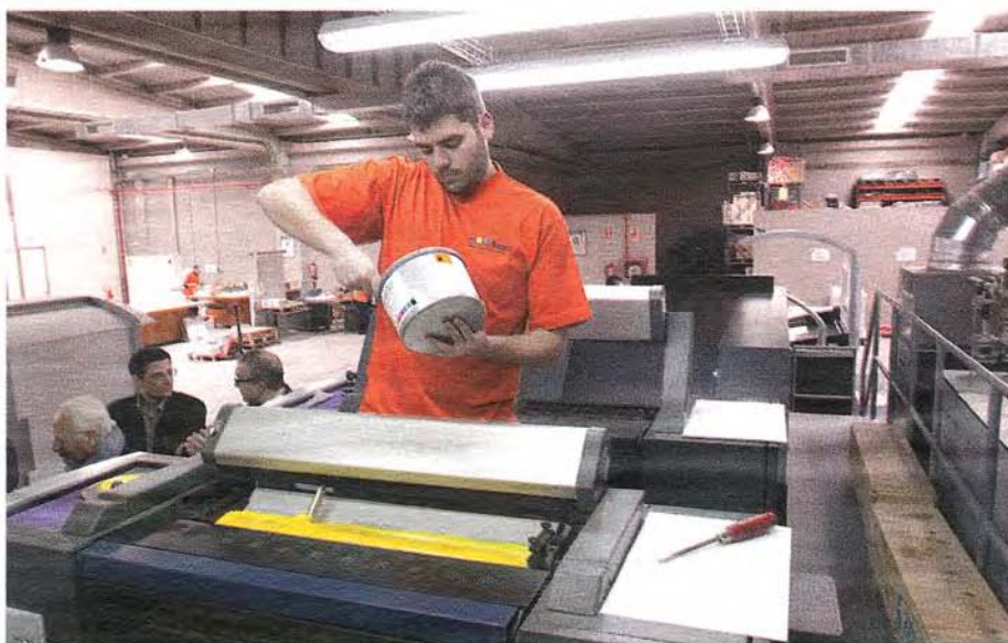
Un operario carga de tinta amarilla la nueva máquina de impresión Heidelberg del sistema Cool-Print.
